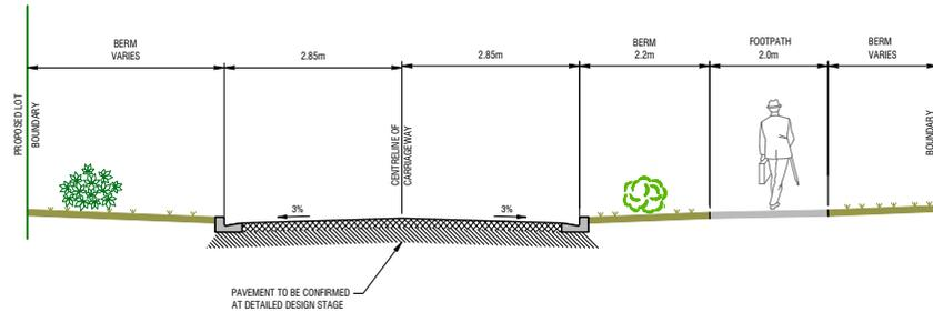
**B** TYPICAL ROAD CROSS SECTION - KERB & CHANNEL
